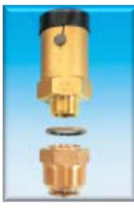
Sigurnosni ventil s cilindričnim navojem na donjem kontrolnom ventilu. Nepropusnost osigurana metalnom podloškom s uloženim gumenim prstenom. Tlak baždarenja: 17,65 bar
